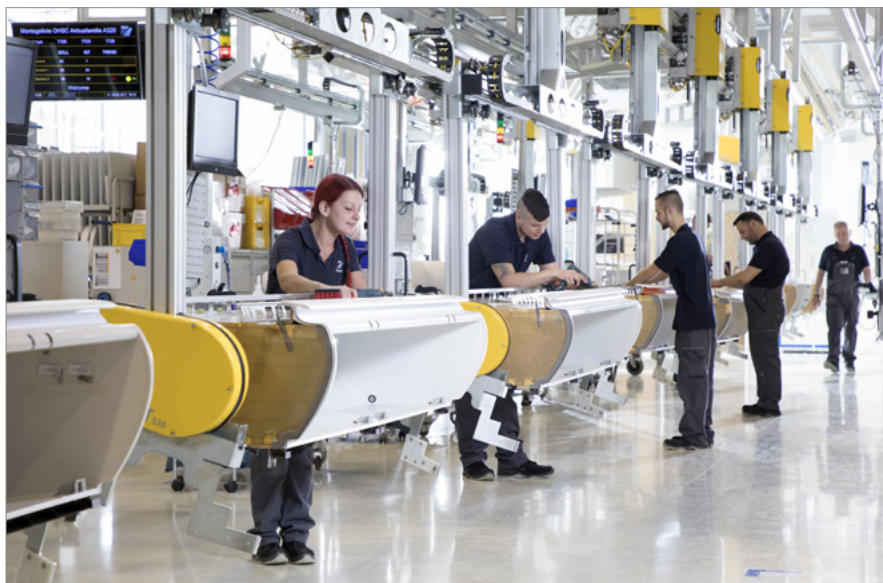
Getaktete Montagelinie für A320 Gepäckablagen im Stammwerk in Ried im Innkreis in Oberösterreich.
